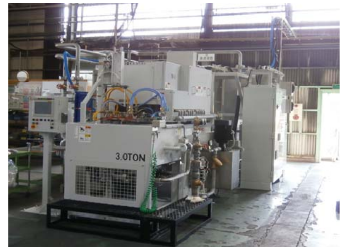
7月に設置完了した高周波焼き入れ機
